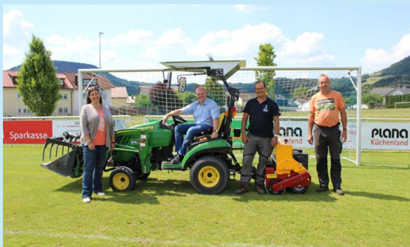
Für das Sportgelände „Auf der Höhe“ wurde ein weiteres Gerät angeschafft, das mit dem John Deere über die 3-Punkt-Aufnahme verbunden und von der Zapfwelle angetrieben wird: ein Nachsaatgerät. Beim Pressegespräch stellten es (v.l.) Ortsbaumeisterin Maren Zengerle, Schultes Michael Rembold, Harald Kreuzer und Hubert Ocker vor.
