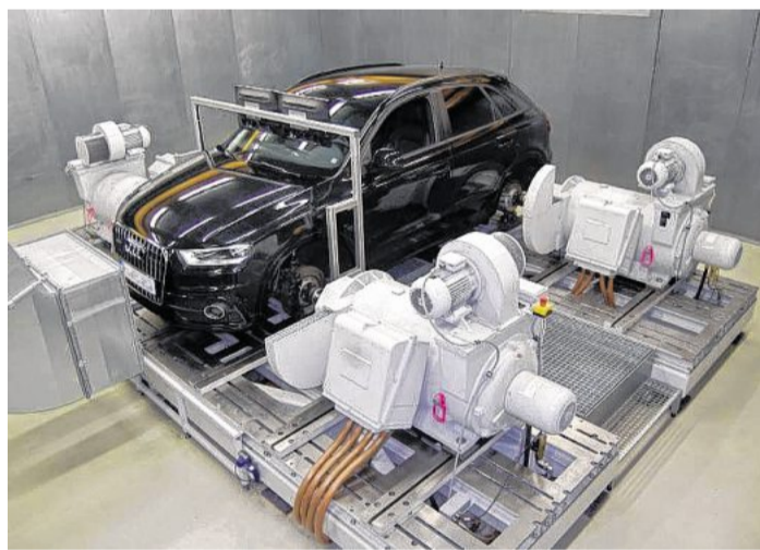
Moderner Road-to-Rig R2R 4x4-Antriebsstrangprüfstand.
