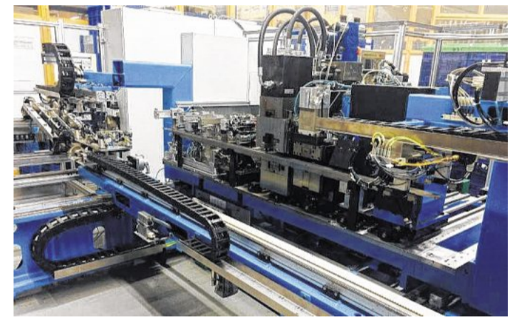
Vollautomatische Rohrendenumformmaschine mit optischer Messprüfung
