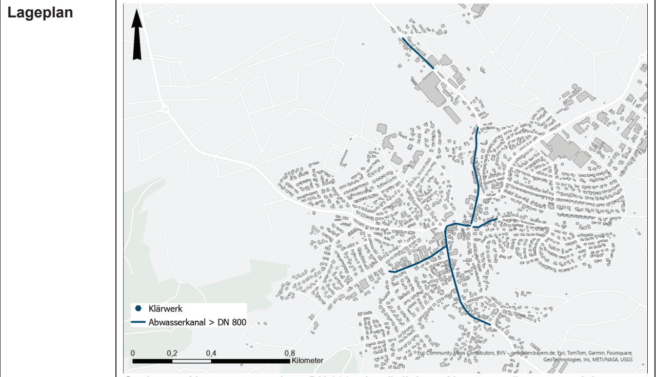
Geeignete Abwassersammler > DN 800 mit möglichem Abwasserwärmepotenzial
